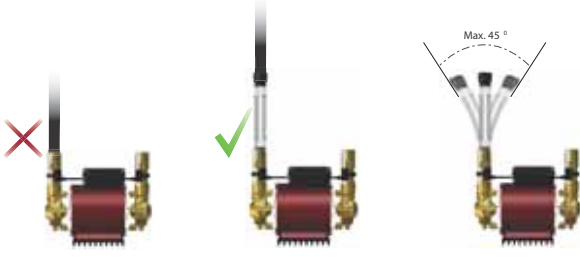
Şekil 18 Esnek hortumların bağlanması
