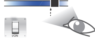
Şekil 28 Çalıştırdıktan sonra sızıntı kontrolü yapın.
